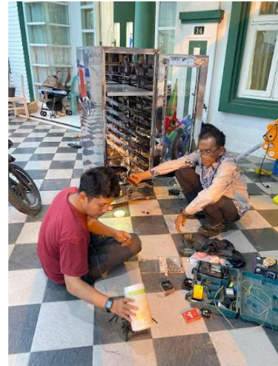
Gambar 4. Perakitan kontrol suhu di alat proofer
